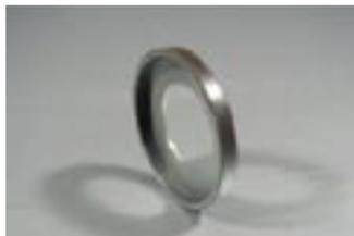
Magnet wird in der Vulkanisation durch einen chemischen Stoffschluß hergestellt. Gleichzeitig wird eine Ausrichtung der Magnetpartikel entsprechend der späteren Funktionsrichtung eingebracht. Die für die Messung notwendige magnetische Codierung wird mit hochpräziser Anlagentechnik aufgebracht.
