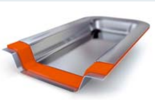
Swissply-Solutions: In der unteren Edelstahl-schicht wird die Wärme induziert und über den Alu-Kern zügig nach oben geleitet.
