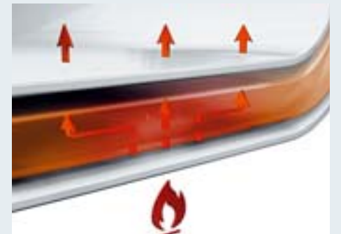
me: Oberhalb der Curie-Temperatur ist eine weitere Erhitzung unmöglich, das Material kontrolliert sich selbst Bilder: Rieber
